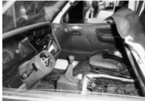
写真5 ステアリングホイールがはずされている。
