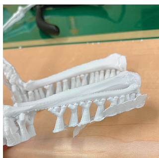
図3 出力失敗例(左)、サポート材(中)、骨格の上半身出力結果(右)
