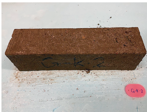
写真1 現在の施工法で作成した供試体劣化状況 13) (72サイクル)
