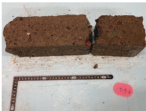
写真2 1960年代の施工法で作成した供試体劣化状況 13) (72サイクル)
