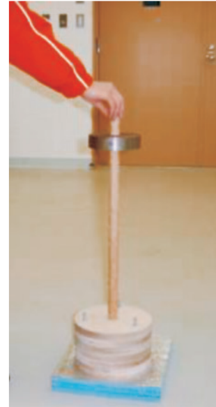
図 20 模型転倒実験 1)
