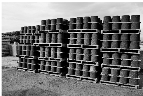
写真－2 磯焼け対策として海中に投入する堆肥分解性ブロック（＝2020年9月，筆者撮影）
