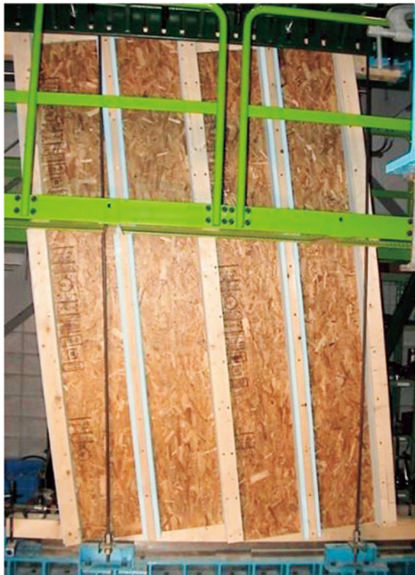
写真1 A450の試験終了時の状況 (真のせん断変形角：1/9)
