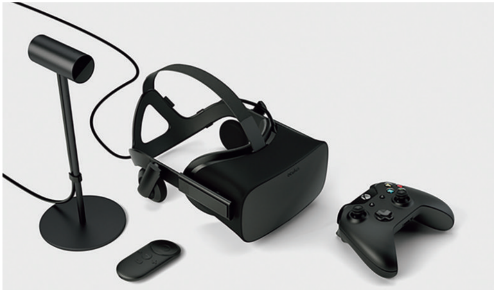
図 1 Oculus Rift 初期出荷内容，中央部が Rift 本体，左端が Sensor，その手前 Oculus Remote（リモコン），及び右端が Controller（X-BOX ゲームパッド） 1)
