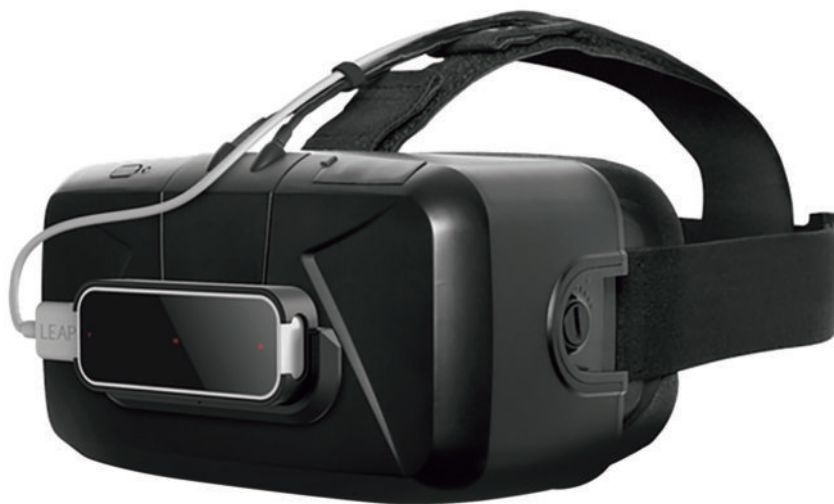
図 4 Oculus DK 2 の正面に Leapmotion をマウントした状態 3)
