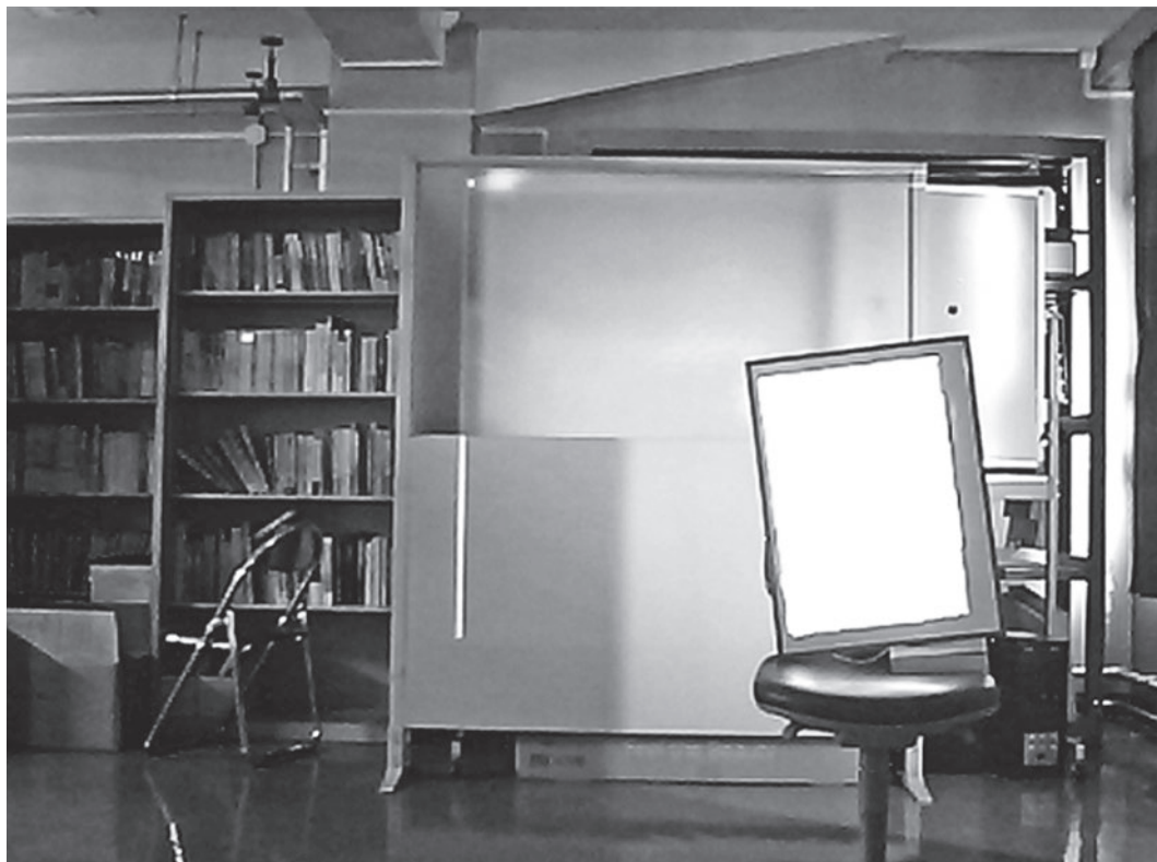
図4 スクリーンを傾けて椅子の上に固定し位置及び傾き角を検出して投影した結果
