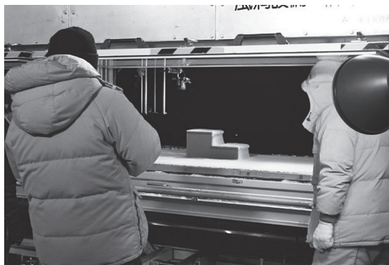
写真6 吹雪風洞実験風景
