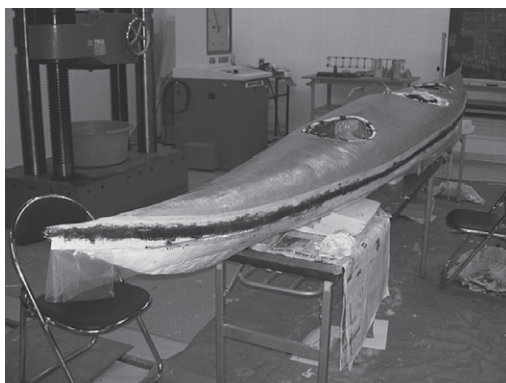
写真-13 エポキシ塗布完了時
