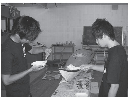
写真-15 デッキ第1層WR-LPU塗布
