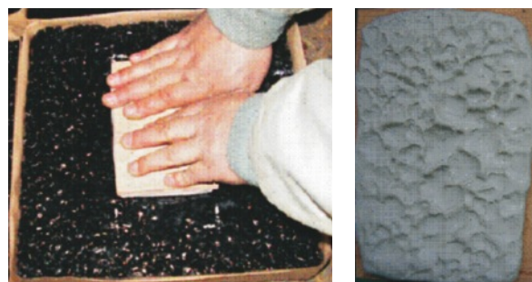
写真－10 パテを用いたMPD測定の様子（左）と舗装に押し付けた後のパテの様子（右）
