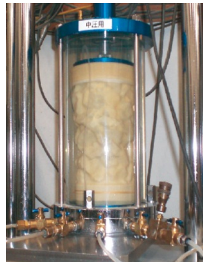
図-11 圧密排水（CD）三軸圧縮試験
